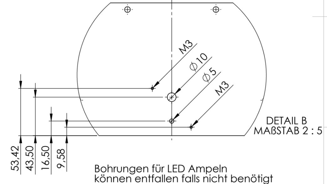
Bohrungen für LED Ampeln
